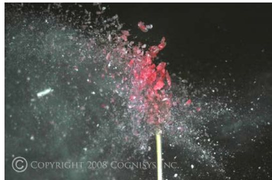
Figuur 20 - Suikerklontje beschoten met een .22 Kaliber geweer
